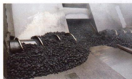
Гранулометрическая сегрегация в бункере Vogelete MT 3000-2 Offset
