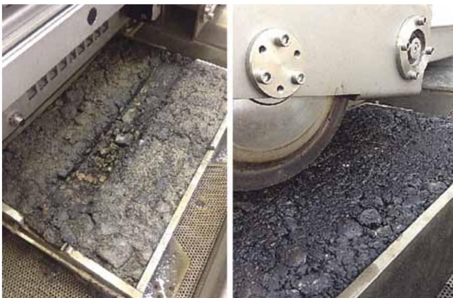
Рис. 4. Образцы-плиты после испытания на колееустойчивость в воде при 60°C с прокатыванием металлическим колесом
