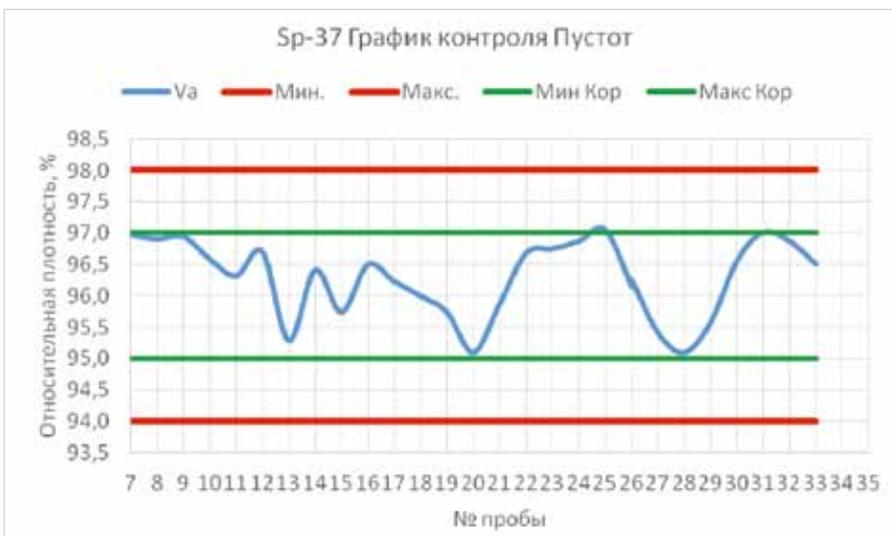
Рис. 6. График контроля пустот через относительную плотность
