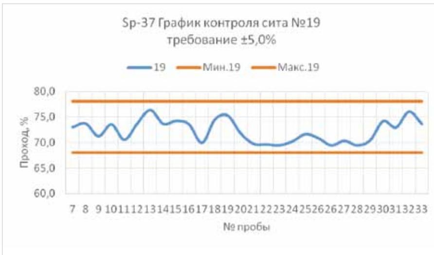
Рис. 7. График контроля отклонений по зерновому составу на сите 19 мм
