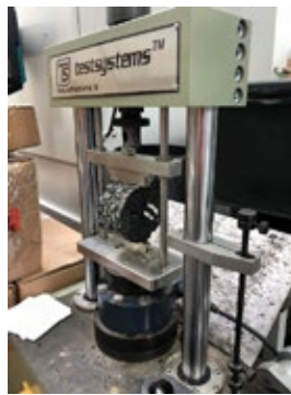
Рисунок 2. Схема испытания на не прямое растяжение цилиндрических асфальтобетонных образцов
