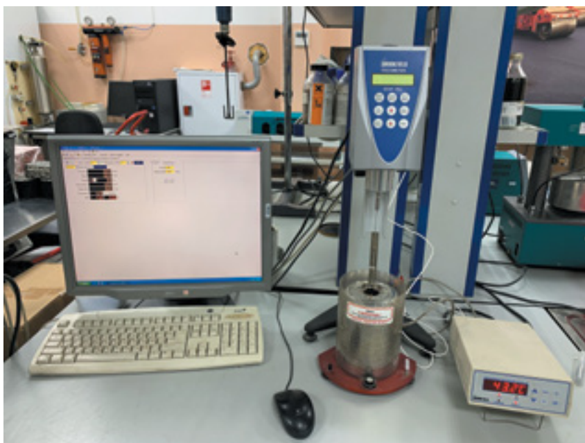
Рис. 1. Вязкозиметр Брукфильда, слева общая схема (1 – контейнер для битума; 2 – шпindelь; 3 – толщина испытуемого битума; 4 – испытуемый битум; R_1 – радиус шпинделя; R_2 – внутренний радиус контейнера)
