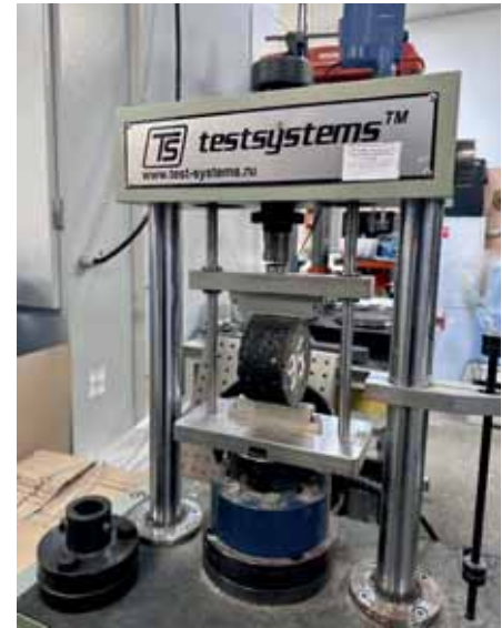
Рис. 5. Оборудование по испытанию на низкотемпературную трещиностойкость при непрямом растяжении
